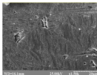
Рис. 2. Мікроструктура сталі після гартування
