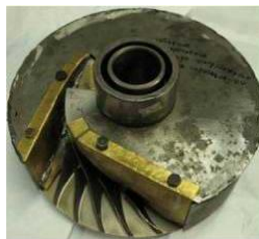
Рис. 4. Приспособление для упрочнения сектора моноколеса компрессора
