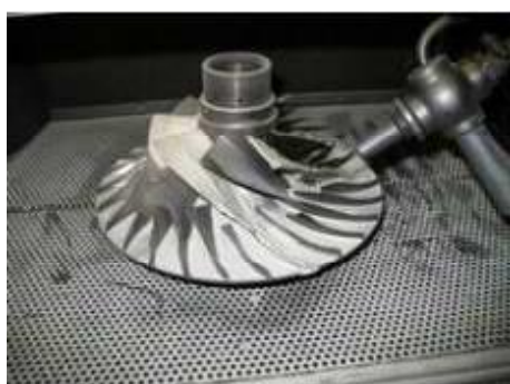
Рис. 5. Общий вид моноколеса компрессора в рабочей зоне установки для ПДУ
