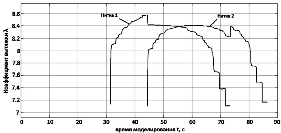
Рис. 4. График изменения вытяжки проката в каждой нитке
