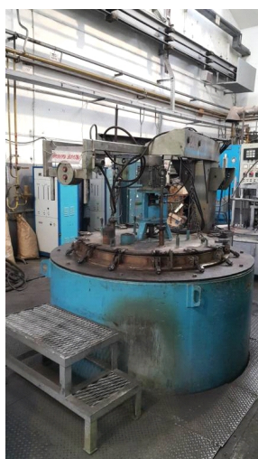
Рис. 3. Электрическая шахтная цементационная муфельная печь СШЦМ (а) и установка контроля и регулирования печных атмосфер КРПА-Ж (б)
