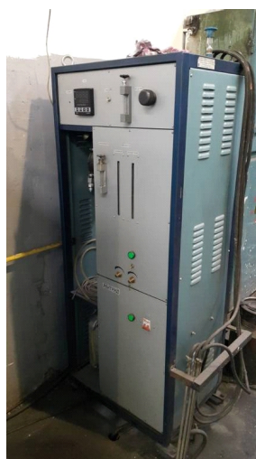
Рис. 3. Электрическая шахтная цементационная муфельная печь СШЦМ (а) и установка контроля и регулирования печных атмосфер КРПА-Ж (б)
