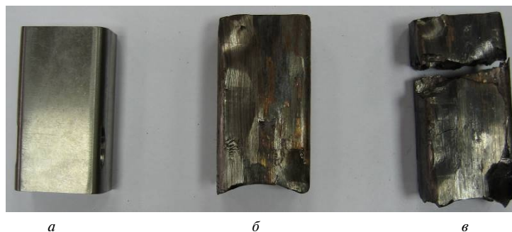
Рис. 1. Вид заготовок из сплава BT8 до и после процесса винтовой экструзии: а – исходная; б – ВЭ ( T = 750 °С); в – ВЭ ( T = 650 °С)
