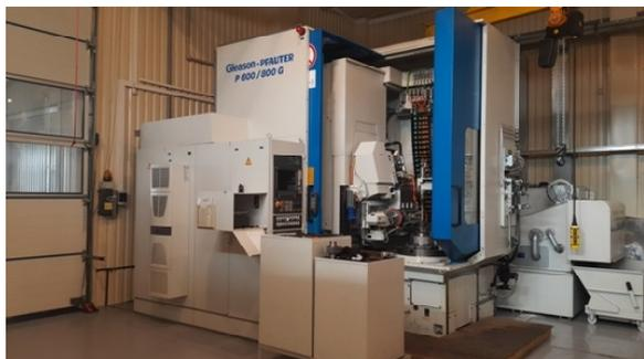
Рис. 2. Профишлифовальный станок Gleason-PFAUTER P 600/800 G
