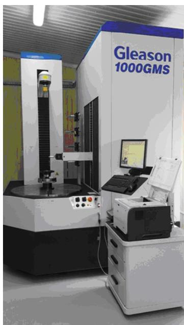
Рис. 3. Измерительная машина GLEASON 1000 GMS
