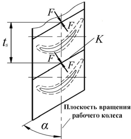
Рис. 1. Схема взаимодействия контактных поверхностей бандажных полок лопаток
