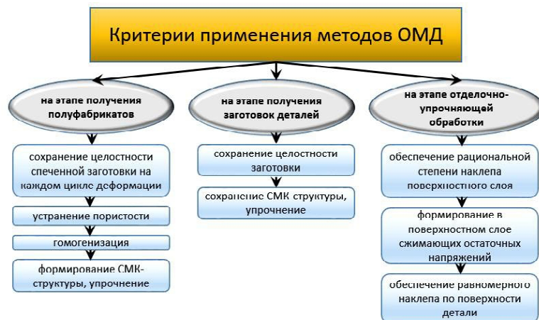
Рис. 1. Критерии применения методов ОМД на различных этапах технологического процесса изготовления деталей ГТД
