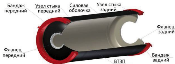
Рис. 1. Конструкция корпуса из углепластика
