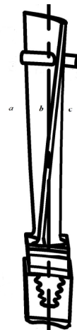
Рис. 1. Модель секции (сектор диска с лопаткой и участками связей) для расчетов колебаний рабочих лопаток турбомашин
