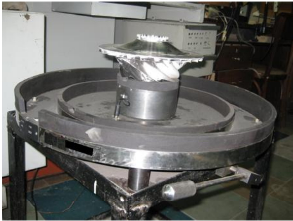
Рис. 1. Установка для збудження та демпфування лопаток
