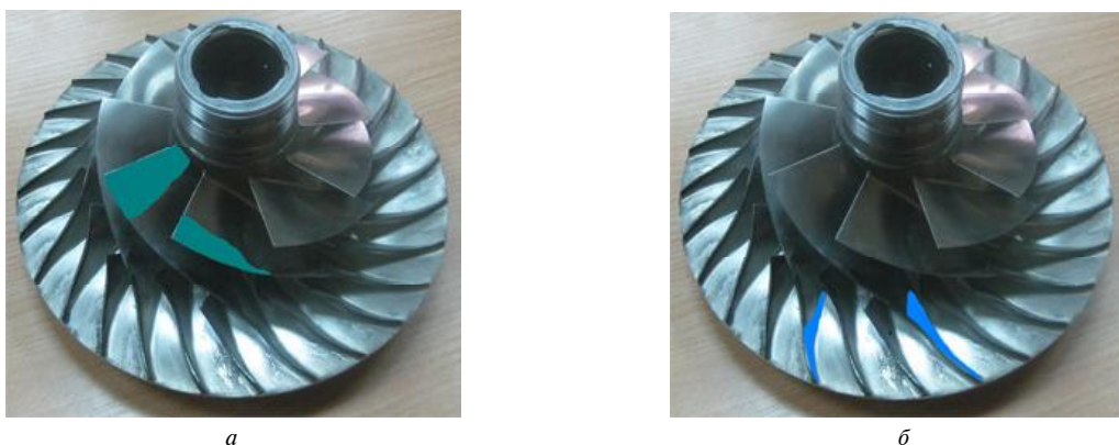
Рис. 6. Позначення місць знімання прошарку матеріалу при доведенні частот власних коливань: a – верхня частина пера великої лопатки відцентрового колеса, б – нижня частина
