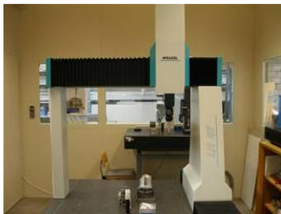
Рис. 3. Контрольно-вимірвальна машина Wenzel LH-87
