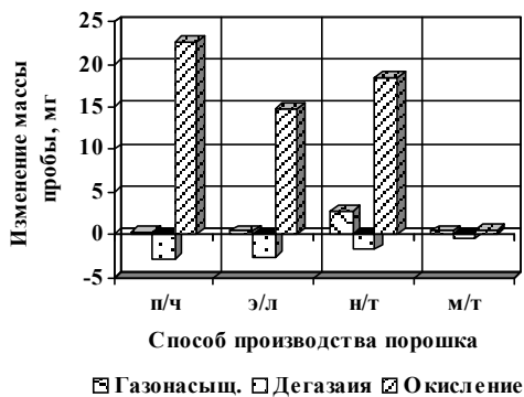
Рис. 7. Изменение массы пробы титанового порошка при нагреве в зависимости от способа его производства
