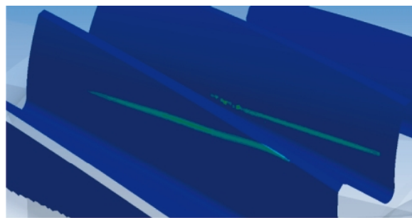
Рис. 10. Картина распределения контактных напряжений по зубьям шестерни Z_7 с оптимальными параметрами продольной модификации
