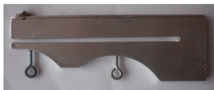
Рис. 3. Штатив для крепления камеры на образце: 1 – тело штатива; 2 – прижимные винты для фиксации штатива на образце; 3 – щель для образца; 4 – винт крепления камеры на штативе
