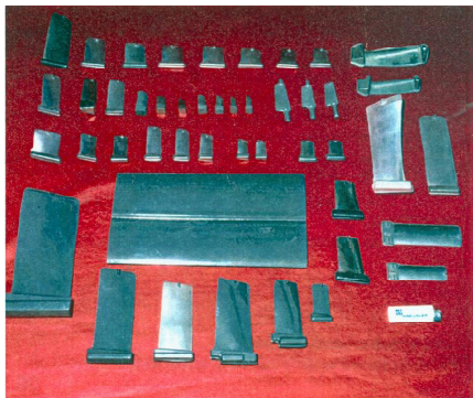
Рис. 5. Заготовки лопаток, изготавливаемые точной штамповкой из периодического проката
