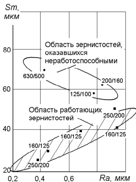
Рис. 1. Пример корреляционной связи между параметром шероховатости Ra и шагом микронеровностей Sm
