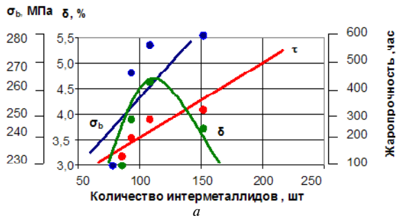
Рис. 4. Влияние количества интерметаллидов на свойства отливок из сплава Мл-5, легированного: а – Nd, б – Ti, в – Y
