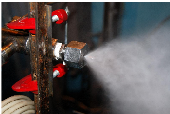
Рис. 3. Струйная форсунка с рассекателем игольчатого типа
