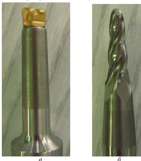
Рис. 10. Инструмент для плунжерного (а) и строчного (б) фрезерования
