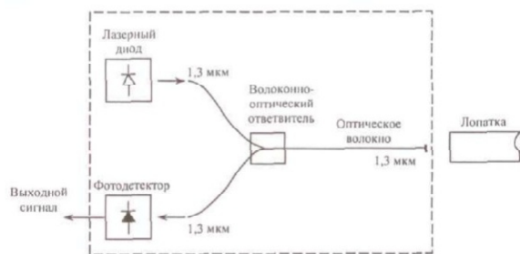
Рис. 1. Структурная схема волоконно-оптического интерферометра Фабри-Перо
