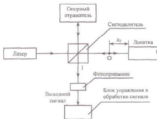
Рис. 2. Структурная схема лазерного интерферометра
