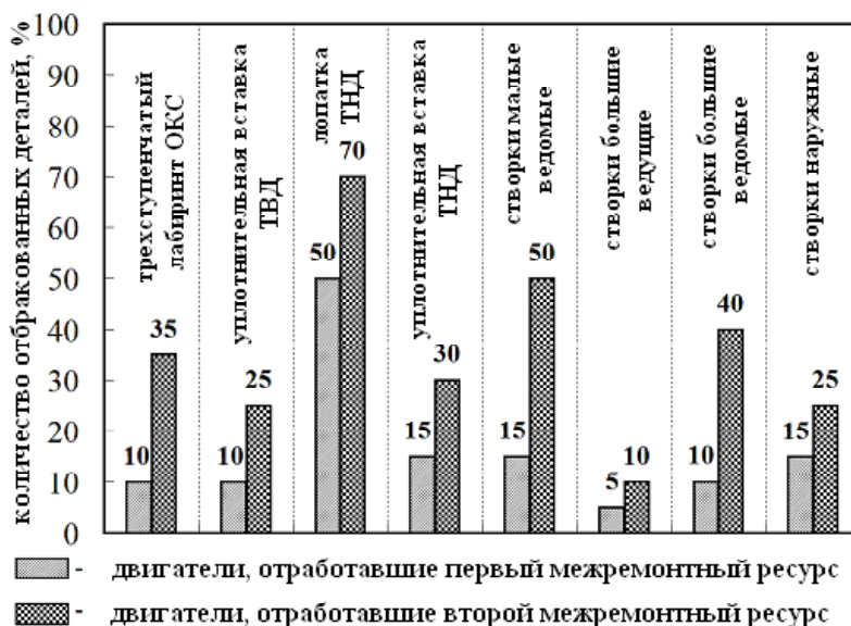
Рис. 14. Износ элементов горячей части ТРДДФ
