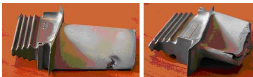
Рис. 6. Разрушение рабочих лопаток турбины высокого давления
