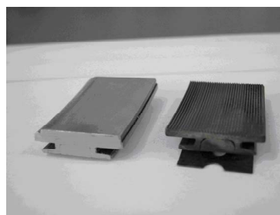
Рис. 8. Износ уплотнительных вставок
