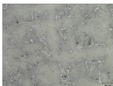
Рис. 6. Микроструктура рабочей лопатки из сплава ЖС26-ВИ после проведения операции ГИП (вариант 1)
