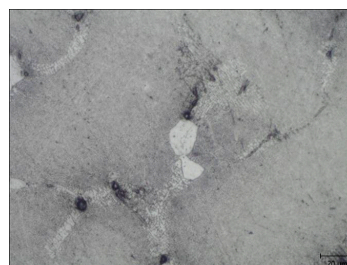
Рис. 5. Микроструктура рабочей лопатки из сплава ЖС26-ВИ в исходном состоянии до ГИП (вариант 0)
