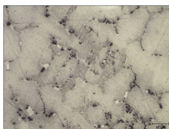
Рис. 5. Микроструктура рабочей лопатки из сплава ЖС26-ВИ в исходном состоянии до ГИП (вариант 0)
