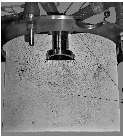
Рис. 9. Стенд экспериментального определения распределения магнитной индукции:
