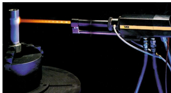
Рис. 1. Внешний вид устройства JP-5000
