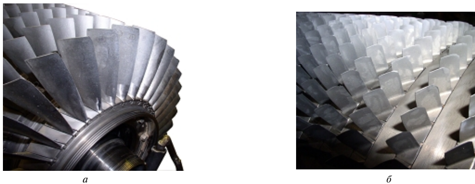
Рис. 5. Общий вид неравномерного износа пера лопаток (а) и ротора компрессора (б) турбовального двигателя после эксплуатации в условиях запыленной атмосферы
