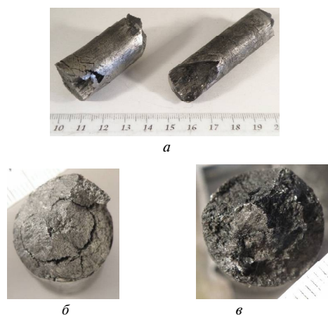
Рис. 3. Общий вид (а) и поверхность переднего торца (б, в) образцов, подвергнутых гидроэкструзии
