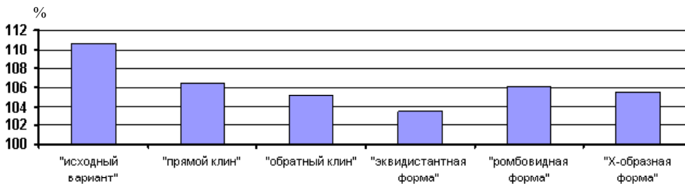
Рис. 8. Графическое отображение расхождения (в %) величин частот 1 крутильной формы собственных колебаний, полученных в результате модального анализа МКЭ, относительно средней, полученной экспериментально
