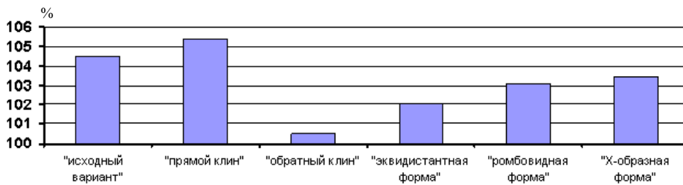
Рис. 6. Графическое отображение расхождения (в %) величин частот 1 изгибной формы собственных колебаний, полученных в результате модального анализа МКЭ, относительно средней, полученной экспериментально
