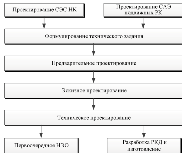
Рис. 1. Укрупненная схема процесса проектирования СЭС и САЭ
