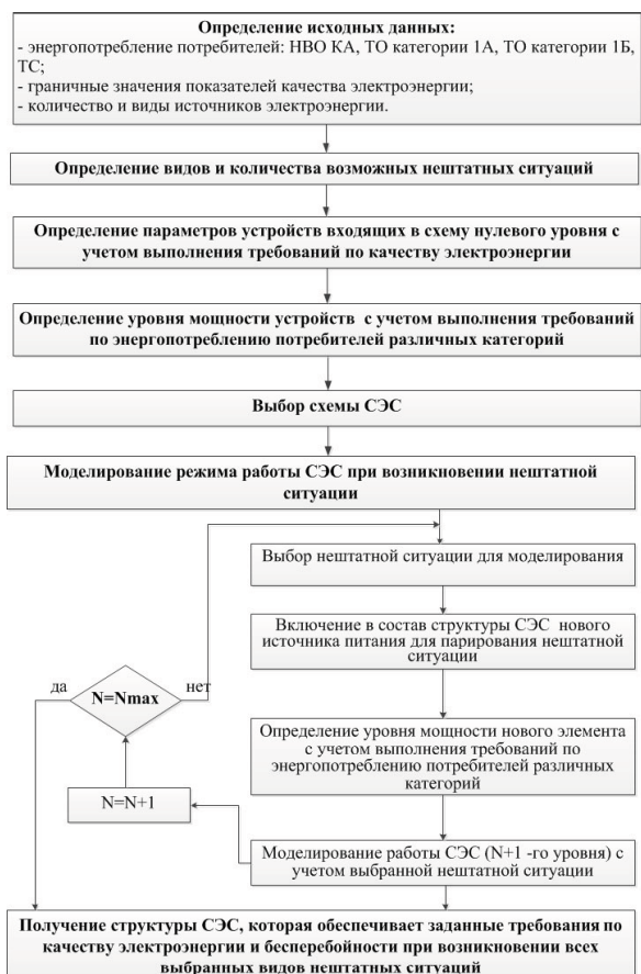
Рис. 2. Алгоритм процесса формирования структуры СЭС с учетом моделирования нештатных ситуаций
